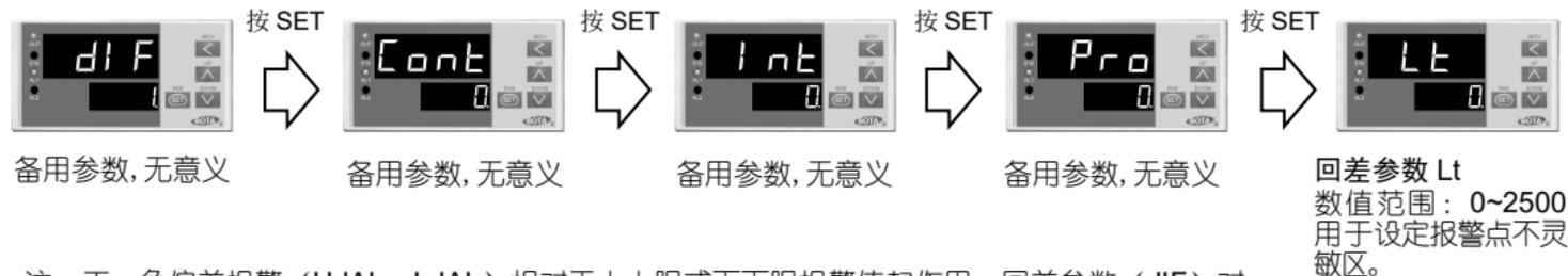
注: 正、负偏差报警 (HdAL、LdAL) 相对于上上限或下下限报警值起作用, 回差参数 (dIF) 对所有报警都起作用。例如: 上上限或下下限报警值=200, HdAL=5, dIF=1, 那么上升阶段测量值达到 206 (200+5+1) 时正偏差报警动作; 下降阶段测量值到 204 (200+5-1) 时正偏差报警解除。
